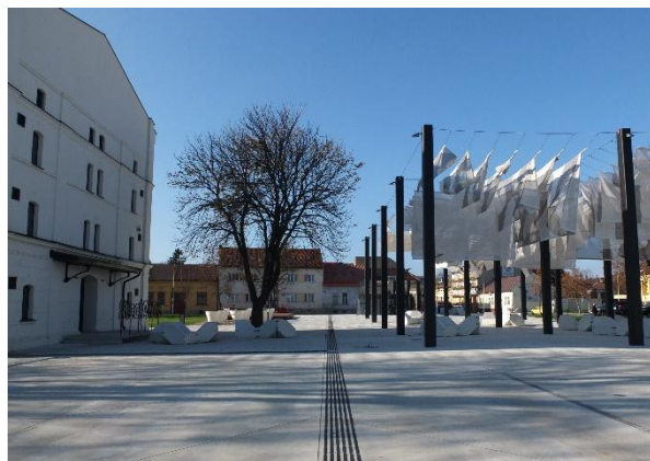
Príklad vhodného riešenia orientačného systému pre ľudí so zrakovým postihnutím, ktorým pomáha umelá vodiaca línia (reliéfny kontrastný pás) udržať smer pohybu v areáli Kulturparku v Košiciach, najmä na širokých priestranstvách.
